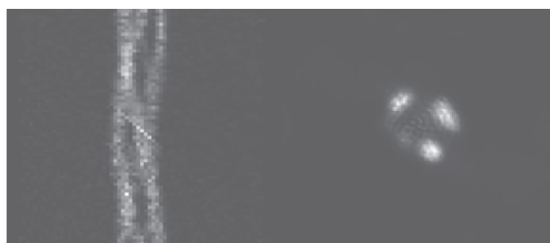
图7 整环探测器正弦图(左)与重建图(右)
