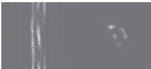
图8 非整环探测器正弦图(左)与重建图(右)
