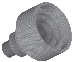
图 12 锥形橡胶簧有限元模型
