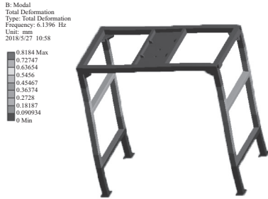
图 6 1 阶模态变形图
