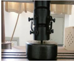
图2 橡胶静态压缩
