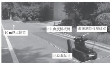
图3 移动机器人实验场地标定
