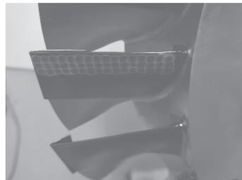
图11 整体叶盘的激光喷丸
