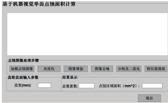
图1 基于机器视觉单齿点蚀面积率计算 GUI 界面
