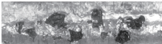
图2 放大 100 倍后单个齿面点蚀灰度图
