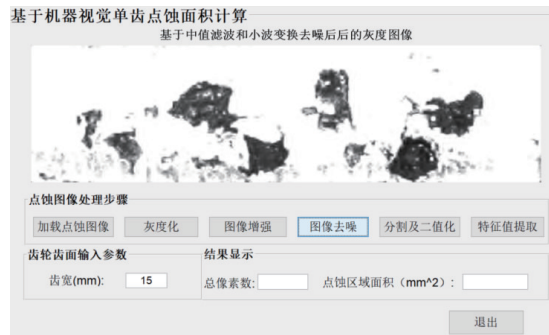
图4 消除椒盐和高斯混合噪声后的灰度图
