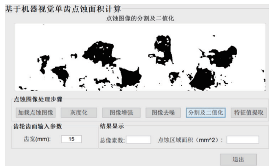
图5 点蚀图像分割后的二值图像
