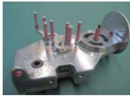
图7 空气活塞式阻尼张力控制器
