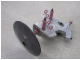
图6 油阻尼式张力控制器
