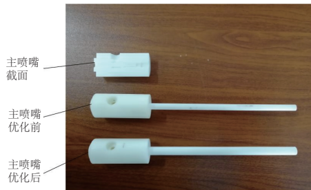
图16 优化前后主喷嘴模型图
