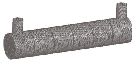
图 3 换热器网格划分图
