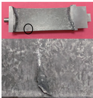
图2 发生短路的试件
