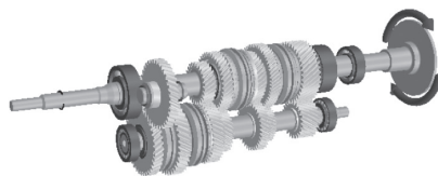
图4 变速箱轴齿系统仿真模型图
