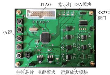
图5 电路板实物
