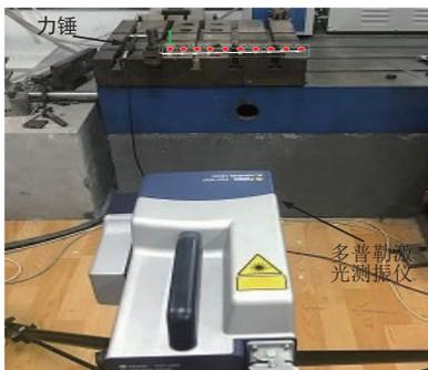
图 3 卡箍直管系统模态试验
