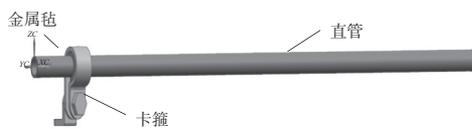
图5 卡箍直管系统几何模型
