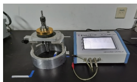
图 4 阻抗分析仪测量超声刀柄谐振频率
