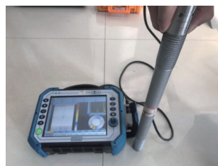
(b) 螺栓拆卸后验证
