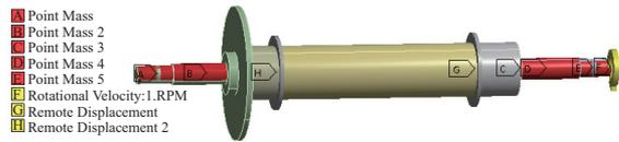
图 2 转子系统的动力学模型
