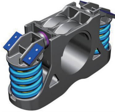
图3 顶置式斜楔轴箱悬挂结构
