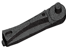
图5 换向器网格划分示意图
