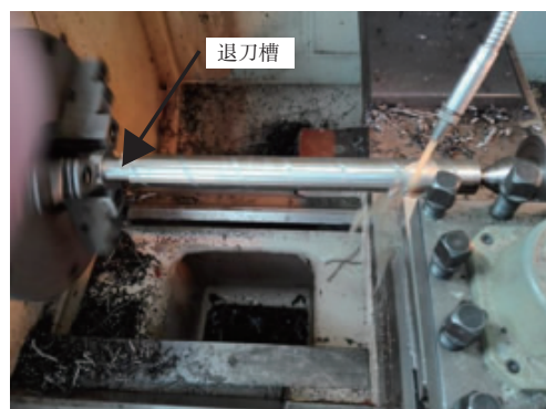
图5 六头矩形螺纹加工图
