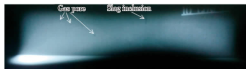
图5 堆敷速度30 cm/min的高氮钢增材构件缺陷分布
