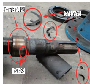
图 4 损坏的主轴和支撑轴承
