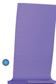
图 2 钢珠冲击叶片有限元模型
