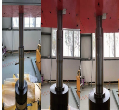
图3 胀筒结构的压溃过程
