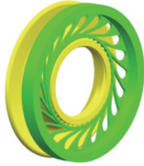
图2 涡轮盘腔内部流体域
