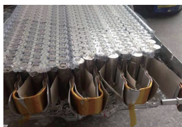
(b) 某电池包液冷系统
