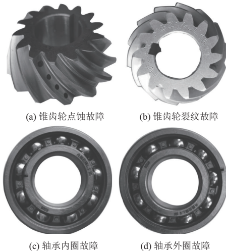
图5 输入级锥齿轮及轴承的故障模拟试验件
