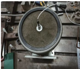
图2 激振器模态测试
