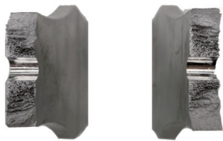
图8 疲劳断裂试样
