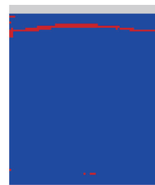
图 11 夹芯壁板面板损伤云图
