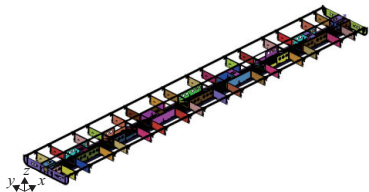
图2 铝合金夹层结构结构示意图
