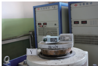
图10 y轴振动试验安装图
