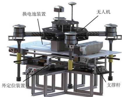
图 1 无人机电池快换系统示意图
