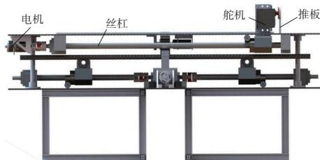
图 4 电池快换装置正视图
