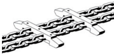
图 1 刮板链条结构示意图
