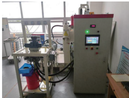
图7 阀类数据采集系统结构示意图
