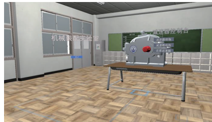
图7 数字孪生减速器仿真模块
