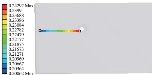
图9 光栅尺安装位置-作动器安装孔路径侧板变形云图
