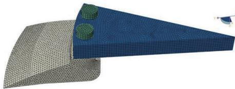
图 3 封头螺栓连接网格模型
