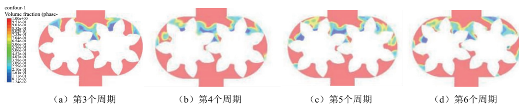
图 3 两齿轮泵第 3-6 个周期内(进口压力 0.05 MPa)气液两相分布云图
