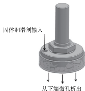
图 9 内喷固体润滑剂砂轮结构图
