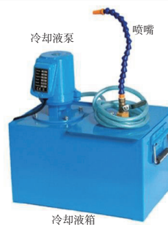
图 1 传统机床冷却液供给系统
