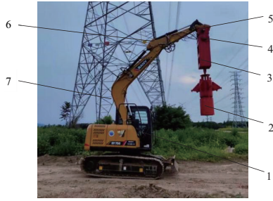
1—手柄支架;2—洛阳铲;3—防摆装置; 4—卷扬机;5—快速连接装置;6—斗杆;7—动臂。
