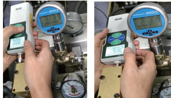
(a) 先导阀打开前作用力值 (b) 先导阀打开后作用力值
