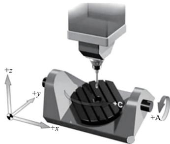
图 1 双转台五轴机床结构简图
