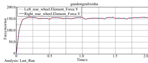
图9 满载 0.1 m/s 右后轮、左后轮的竖直载荷
