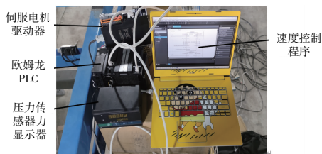
图 13 伺服电机控制和传感器力值显示部分
