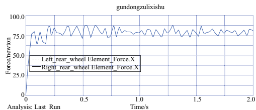
图7 空载 1 m/s 左后轮、右后轮的竖直载荷
