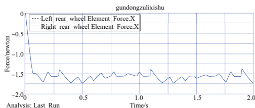
图4 空载 0.1 \text{ m/s} 左后轮、右后轮受到的摩擦阻力
