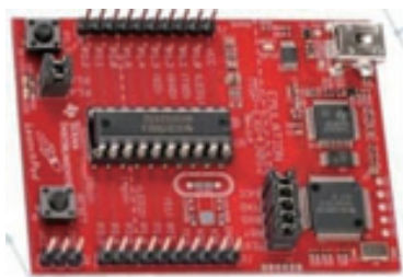
图 12 智能雨刮器控制电路板
