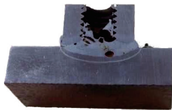
图10 空心螺柱旋弧螺柱焊剖面图
