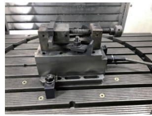
图 4 工件装夹方式
