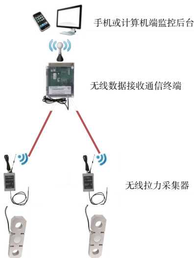
图2 无线拉力、张力采集系统结构示意图
