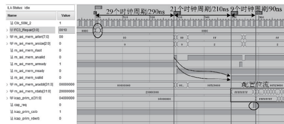
图5 自修复控制器开始传输配置位流实现图
